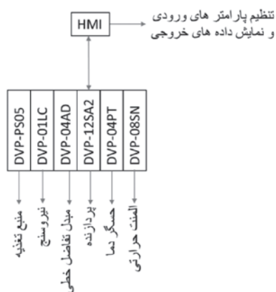
شکل ۴. ارتباط اجزای مختلف دستگاه اندازه‌گیری رفتار خزشی
